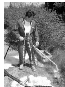
Désherbage thermique à mousse chaude
